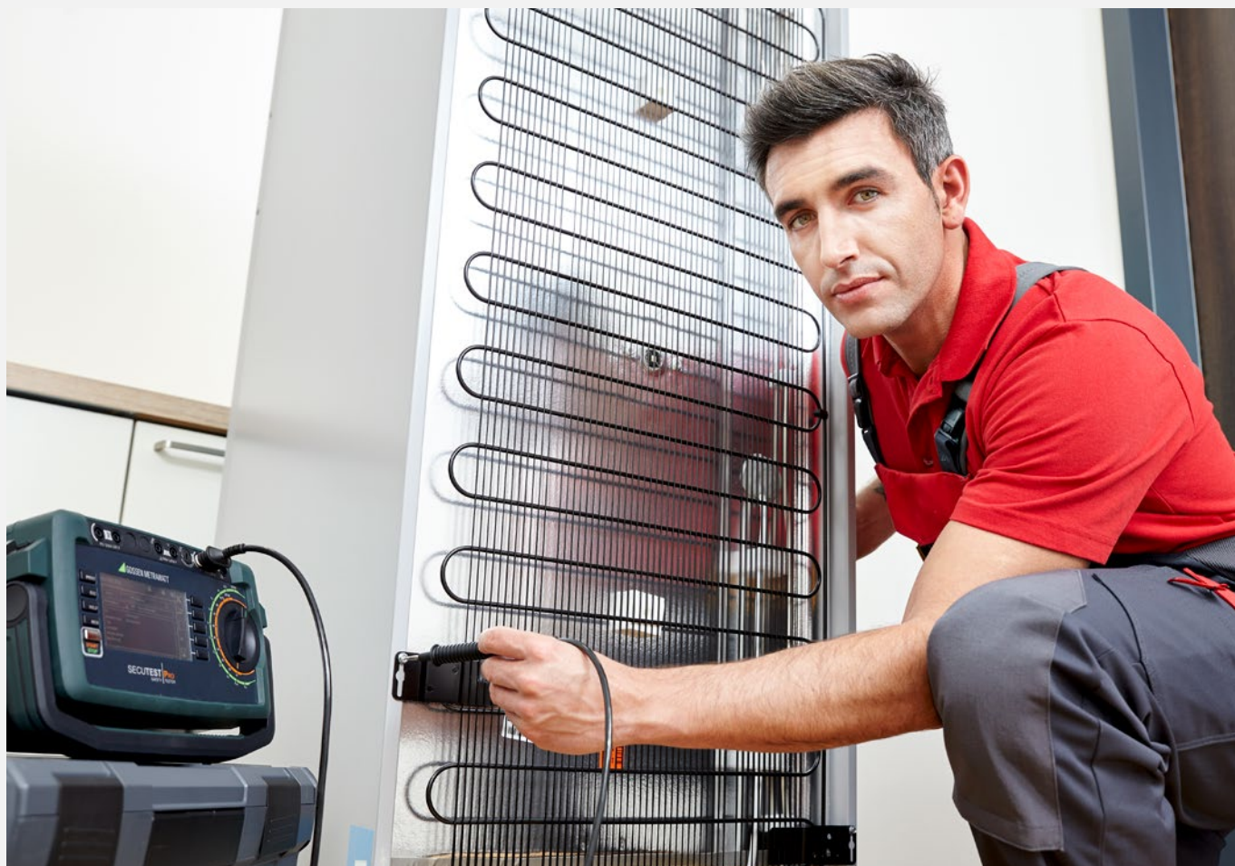
Prüfung ortsveränderlicher Geräte mit SECUTEST
