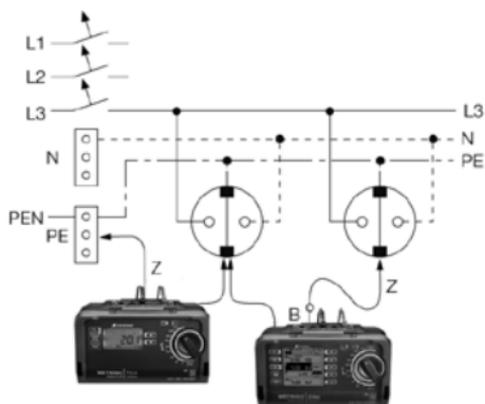
Test: N – PE-Tausch in Steckdosen, N – PE-Brücke öffnen
