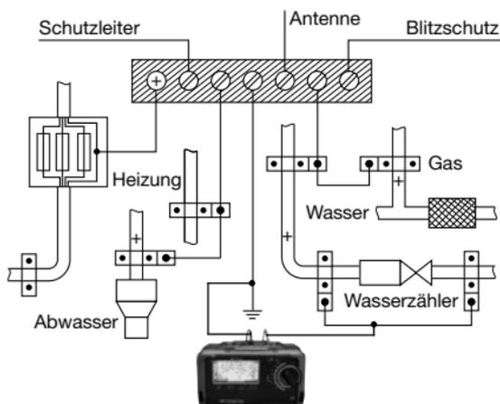
**$R_{LO}$ -Messung der niederohmigen Verbindung des Schutzleiters PE
