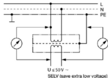
bei Schutzkleinspannung (SELV) durch Sicherheitstransformator
