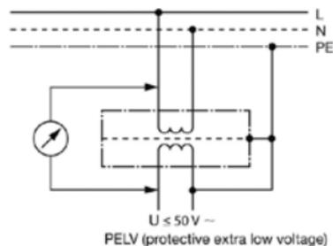
bei Funktionskleinspannung (PELV), durch Sicherheitstransformator
