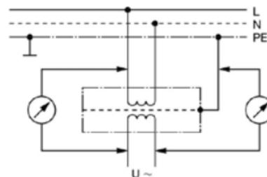
bei Schutztrennung durch Trenntransformator
